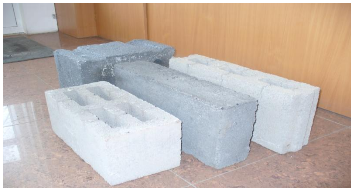
Рисунок 2. Стеновые блоки на основе отходов золы-уноса
